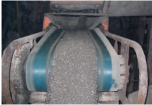
Serie Drago Industria. Resistencia al corte, abrasión, y aceites minerales. Transportadores de rodillos, artesas y elevadores de cangilones. Transporte de arcillas, fertilizantes químicos, materiales a granel.
