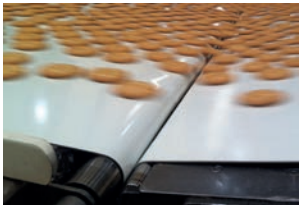
Serie TPU Standard Alimentación. Gran resistencia a aceites y grasas animales y vegetales, no agrietamiento, alto nivel de higiene. Alta resistencia al corte y a la abrasión. Tejidos de baja capilaridad (Wicking Test G11-FDA 2011).
