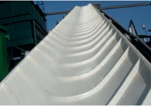
Serie Aster Alimentación. Blancas, FDA. Industria. Verdes y negras. Bandas con cobertura grabada para elevación o descenso de productos envasados o a granel.
