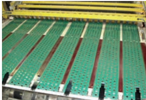
Serie Hipo Industria. Excelente resistencia a la abrasión, superior a algunos elastómeros, muy antiestáticas, empalme por fusión. Transporte y procesamiento de cartón, papel y otros materiales abrasivos.
