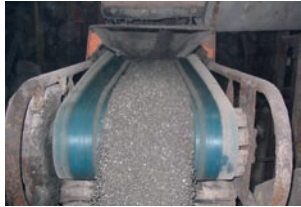
Serie Drago Industrie. Widerstandsfähig gegen Schnitte, Abrieb und mineralische Öle. Transport von Ton, Getreide und Kunstdünger.
