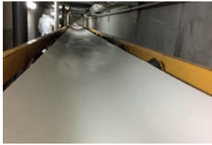
Serie Febor Industrie. Grün – Verpackte oder lose Produkte ohne Öle oder Fette. Schwarz – Schwer entflammbar, Flughäfen, Logistikzentren. Lebensmittel: Weiß und blau - FDA Lebensmittelqualität, flammwidrig, abriebfest. Zucker, Karotten und anderes Gemüse.
