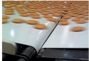
Standard TPU Serie Lebensmittel. Lebensmittel. Besonders beständig gegen tierische und pflanzliche Öle und Fette, keine Risse, besonders gute Hygiene. Sehr abrieb- und schnittfest. Gewebe mit besonders geringer Kapillarwirkung (Wicking Test G11-FDA 2011).
