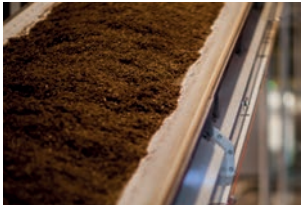
Serie Poler - Tabak Tabak- Polyesterbänder erfüllen den Pyrolysetest. Sie sind sehr gut für hohe Temperaturen geeignet.
