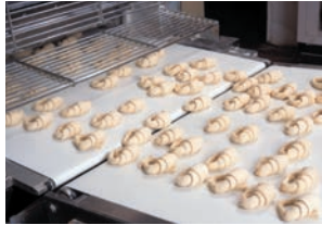
Serie Clina Lebensmittel: Besonders beständig gegen pflanzliche Öle und tierische Fette. Ungiftig. PVC und PU.
