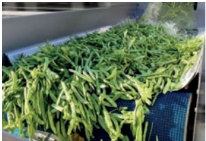
Serie Washflow Lebensmittel. Besonders beständiges Kunststoffgitterband. Ein neues Konzept für das Waschen und transportieren von Gemüse, Obst und gefrorenen Lebensmitteln, sowie zum Ableiten von Flüssigkeiten und das Aussieben von festen Abfällen.
