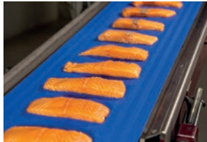
Premium TPU Serie Lebensmittel. Bakteriostatische Mischung mit starker und lang anhaltender antimikrobieller und Anti-Biofilm Wirkung (ISO 22196). Hydrolysebeständig. Gewebe mit besonders geringer Kapillarwirkung (Wicking Test G11-FDA 2011).
