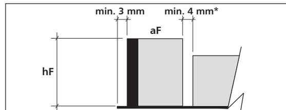
\*Si le tasseau transversal est du type NL.070 ou NL.080, la marge minimum de 4 mm sera agrandie jusqu'à 5 mm.
