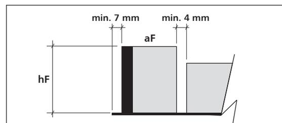
Disposition de tasseaux et profils "runer" PU sans base.
