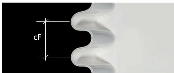
La distance entre les tasseaux transversaux doit être un multiple du pas - cF - si on désire la faire coïncider avec l'ondulation du "runer".
