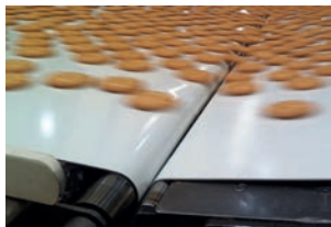
Serie TPU Standard Alimentación. Gran resistencia a aceites y grasas animales y vegetales, no agrietamiento, alto nivel de higiene. Alta resistencia al corte y a la abrasión. Tejidos de baja capilaridad (Wicking Test G11-FDA 2011).
