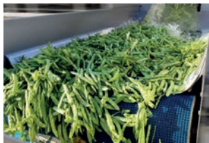
Serie Washflow Alimentación. Bandas de malla plástica de alta resistencia. Lavado y transporte de verduras, hortalizas, frutas y congelados, así como drenaje de líquidos y cribado de restos sólidos.
