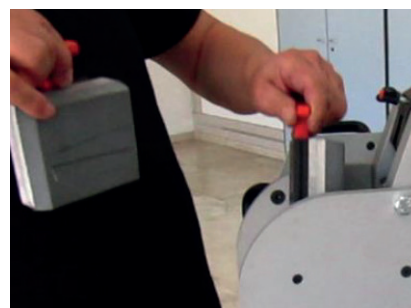
3. Reemplazar el cabezal de corte por el que se encuentra en el alojamiento dispuesto para su resguardo.
