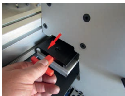
2. Extraer el cabezal por el lado opuesto
