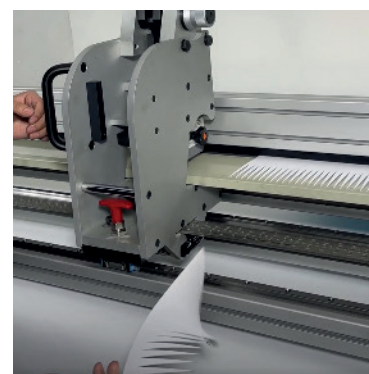
Photo de la matrice de découpe de 90x10 et échantillon de bande découpée.
