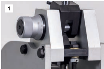
Regulador de presión para ajuste de espesor de corte.
