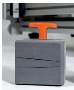
Photo de la matrice de découpe de 90x10 et échantillon de bande découpée.
