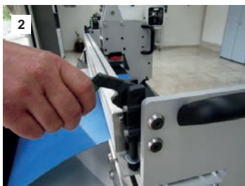
Mecanismo para la fijación de la banda.
