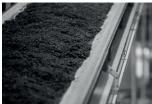
Serie Poler - Tabaco Tabaco. Bandas de poliéster que cumplen el Test pirólisis. Excelentes a temperaturas extremas.
