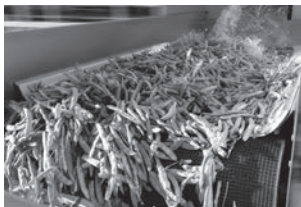
Serie Washflow Alimentación. Bandas de malla plástica de alta resistencia. Lavado y transporte de verduras, hortalizas, frutas y congelados, así como drenaje de líquidos y cribado de restos sólidos.
