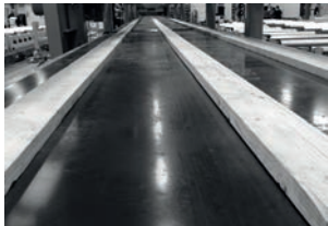
Serie Breda Industria. Gran resistencia a la abrasión, productos químicos y aceites minerales. Gran prestación en condiciones difíciles de trabajo.
