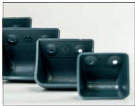
**Material: Polyamid. Antistatisch.** FDA, Vorschrift EU 10/2011 und EC 1935/2004. Maximale Einsatztemperatur 110° Celsius. Anwendung bei Produkten von mittlerer oder kleiner Korngröße, Schleifmittel, Reis, Zucker, Getreide, körniges Tierfutter, Zement, Tonerde, Glas, Kieselerde, Erde, aktive Reinigungsprodukte, Dünger, Salz, etc.
