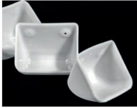
**Material: Polyethylen, weiß.** FDA, Vorschrift EU 10/2011 und EC 1935/2004. Maximale Einsatztemperatur 60° Celsius. Anwendung bei pulverförmigen und körnigen, nicht abrasiven Produkten: Mehle, Tabak, Obst, Tierfutter, Phosphate, pulverförmiger Harnstoff; Lebensmittel im Allgemeinen, chemische Produkte, feuchte und klebende Materialien, etc.
