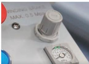
Le système de freinage est contrôlé depuis les régulateurs "Winding Brake" et "Rewinding Brake" situés sur le tableau de contrôle.
