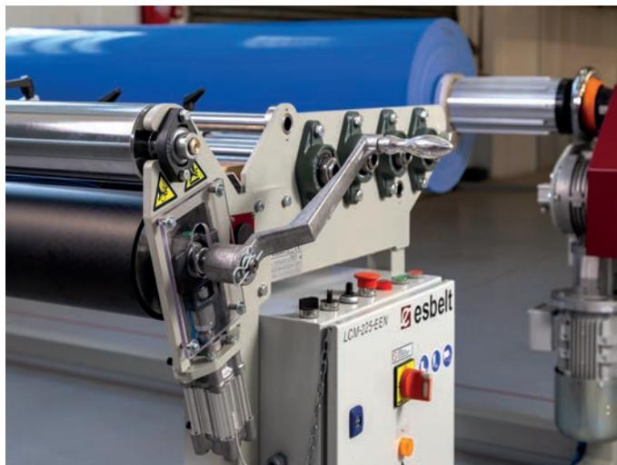
Sélecteur CIL-UP / CIL-DOWN sur le tableau de contrôle habilité dans le cas où la cisaille serait équipée avec l'élément optionnel LCU-KAM-225.
