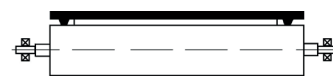
6. Banda con laterales de contención y perfil transversal soportado por un rodillo cilíndrico.
