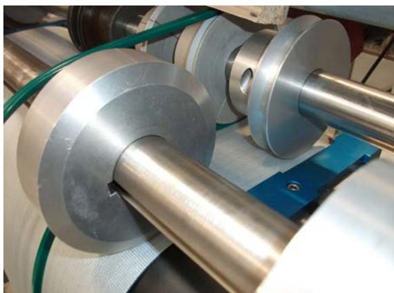
*Détail de la machine en soudant le profil*
