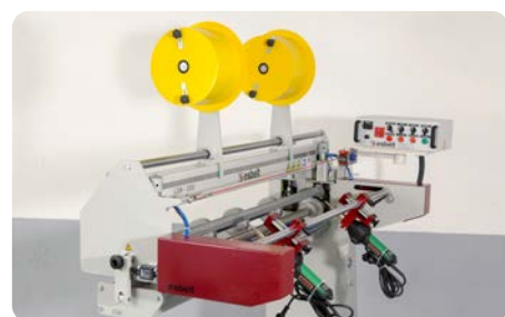
LSM 1200 Machine à souder pour profils longitudinaux
