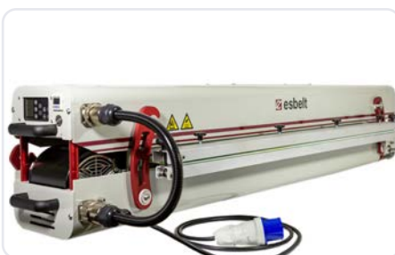
LPBE 1200ACI Presse à refroidissement par air, 1200 mm
