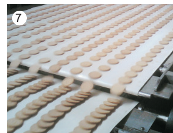
7 Salida de horno: enfriamiento sobre C 09UF.
