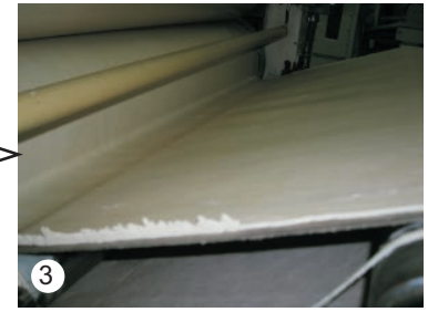
3 Diferentes laminados hasta conseguir el grueso deseado. Bandas de PU o algodón-poliéster. Deben ser mates o tipo "FF" para permitir una buena transferencia
