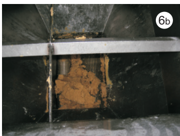
6b El recorte cae en la tolva para volver a ser utilizado.
